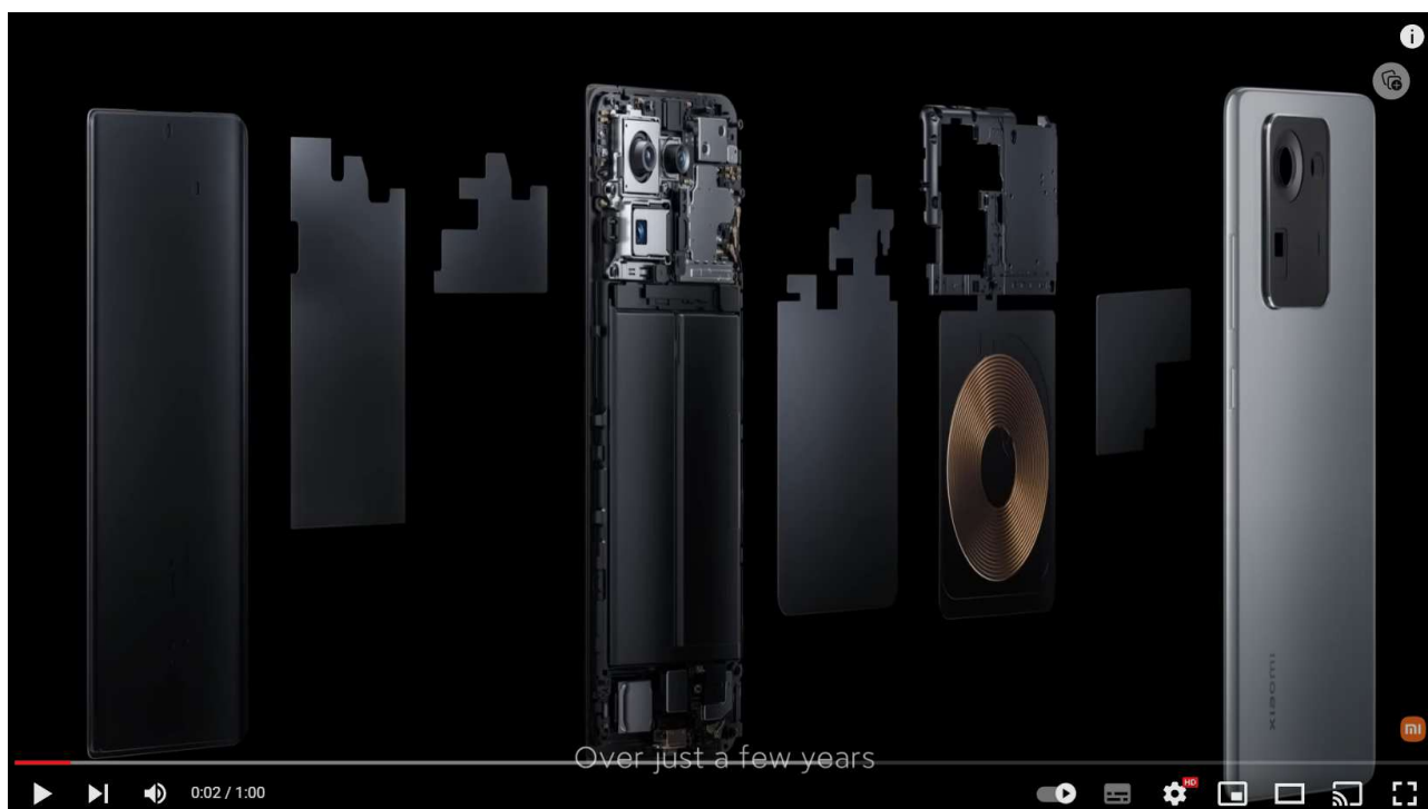
Krótki film ilustrujący budowę i działanie unikatowego, obecnego w smartfonie Xiaomi 13T i 13T Pro, chłodzenia Chłodzenie LiquidCool.
