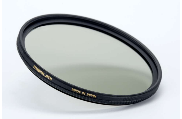
Filtr MARUMI EXUS CPL wyposażono w nisko profilową ramkę typu SLIM, jej wysokość wynosi 4,4 mm dla samej ramki, natomiast 6,4 mm wraz z gwintem zewnętrznym wkręcany w obiektyw, lub inny filtr. Taka budowa znosi ryzyko pojawienia się winiety na obrzeżach filtra.
