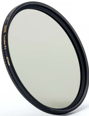
Filtr MARUMI EXUS CPL wyposażono w nisko profilową ramkę typu SLIM, jej wysokość wynosi 4,4 mm dla samej ramki, natomiast 6,4 mm wraz z gwintem zewnętrznym wkręcany w obiektyw, lub inny filtr. Taka budowa znosi ryzyko pojawienia się winiety na obrzeżach filtra.
