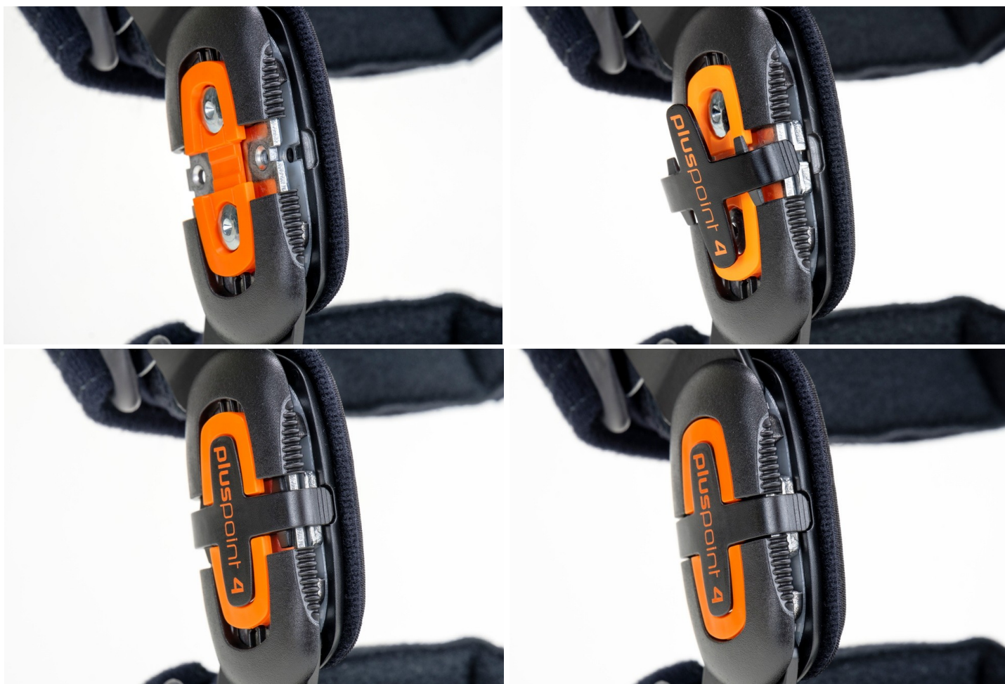
zdjęcia od góry od lewej: mechanizm regulacji kąta zgięcia ortezy w pozycji otwartej, z wyjętą płytką i bloczkami / mechanizm z włożonymi bloczkami określającym kąt zgięcia ortezy, oraz płytką z trzpieniami blokującą go w mechanizmie / mechanizm z założonymi bloczkami i płytką z trzpieniami, z rozsuniętymi pokrywami – po prawej na dole gotowy do pracy mechanizm regulujący kąt zgięcia ortezy.
