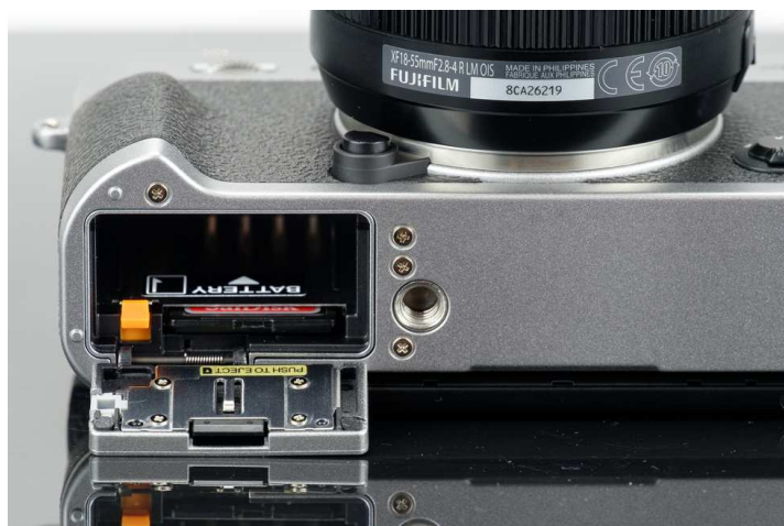
Wielkość ogniwa określa komora aparatów FUJIFILM dla których są dedykowane i wynosi 36 mm x 47 mm x 15,8 mm (szerokość / długość / grubość), natomiast ich waga to 50 gramów.
