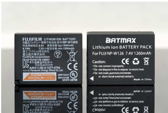
Nie tylko marka NEWELL oferuje zamienniki ogniw NP-W126 i NP-W126S, tu po lewej widoczne oryginalne ogniwo FUJIFILM NP-W126S, oraz starszego typu zamiennik marki BATMAX NP-W126, po prawej oryginalne ogniwo FUJIFILM starszego typu NP-W126.
