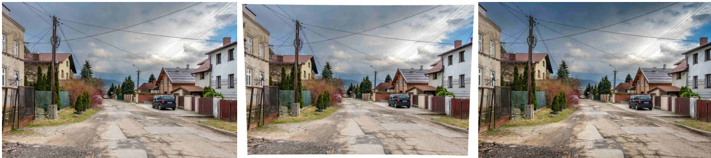
Jednym z typowych problemów zoomów są silne zaburzenia geometrii obrazu, klasycznie największe w przypadku krótkich ogniskowych, nie inaczej jest w przypadku omawianego, gdzie problem ten szczególnie jest dotkliwy w zakresie od 18 do około 35 mm. Po lewej zdjęcie bez korekty geometrii, w środku zakres koniecznej korekty, po prawej finalne zdjęcie po korekcie.
