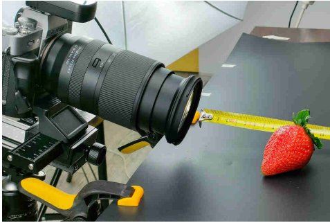
ogniskowa 70 mm – maksymalne powiększenie osiągane jest z dystansu około 8 cm, przysłona od lewej: f/5, f/5.6
